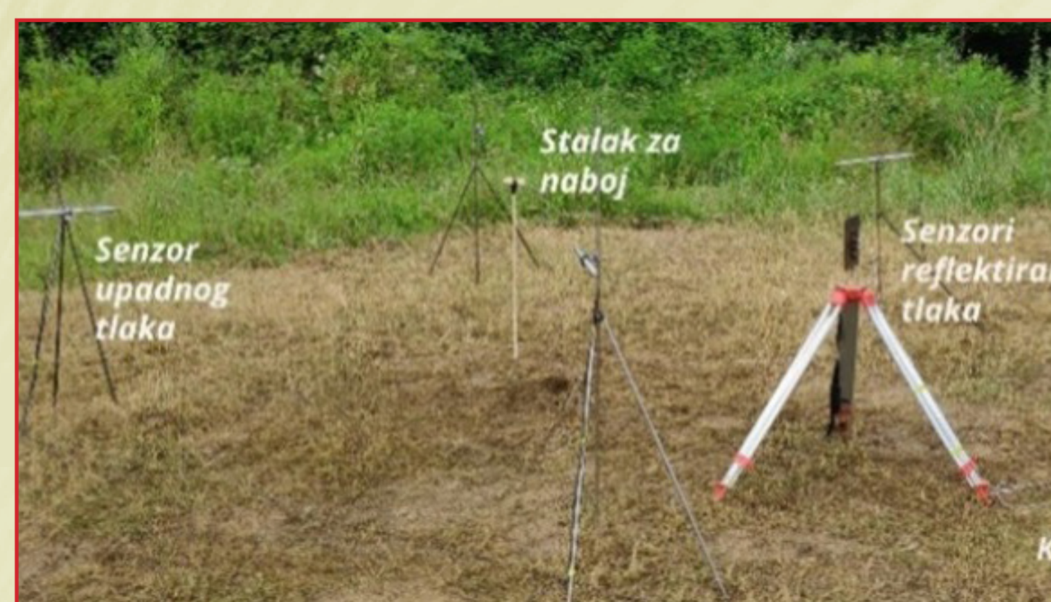
Slika 1. Postav instrumenata za 1. dio eksperimenta (lijevo) i rezultati upadnog tlaka u ovisnosti o obliku naboja (desno).
